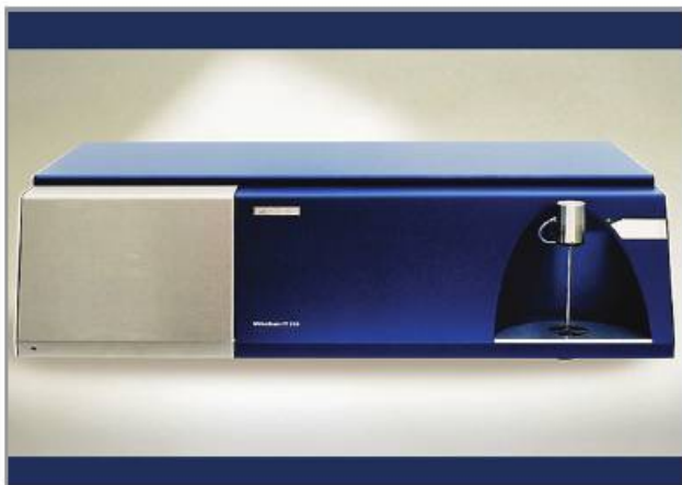
شکل ۱- تصویر دستگاه FOSS MilkoScan -FT۱۲۰
